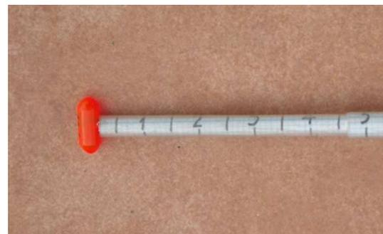
FOTO 2 sopra, il dettaglio di un tastatore fissato in cima all'astina con scala millimetrata
